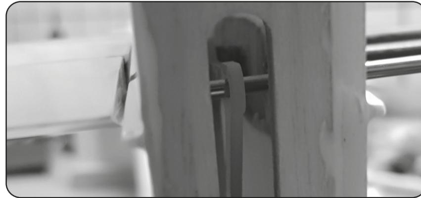
**08** Die zweite Leitwerkshälfte auf die beiden Leitwerksverbinder stecken. **WICHTIG! die zweite Leitwerkshälfte muss sich stramm auf den Carbonleitwerksverbinder schieben lassen. In diesem Fall ist keine zusätzliche Sicherung nötig.**
