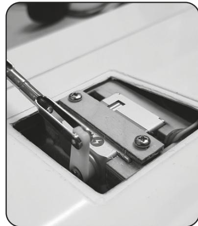
**03** Die Servoschachtabdeckung in der Aussparung der Tragfläche positionieren und z.B. mit Klebeband befestigen. **HINWEIS: Die Servoschachtabdeckung so positionieren, dass der Servohebel und das Gestänge nicht die Abdeckung berühren.** Den Bauschritt 1 – 3 für die Montage und Anschluss des zweiten Querrudersevos wiederholen.
