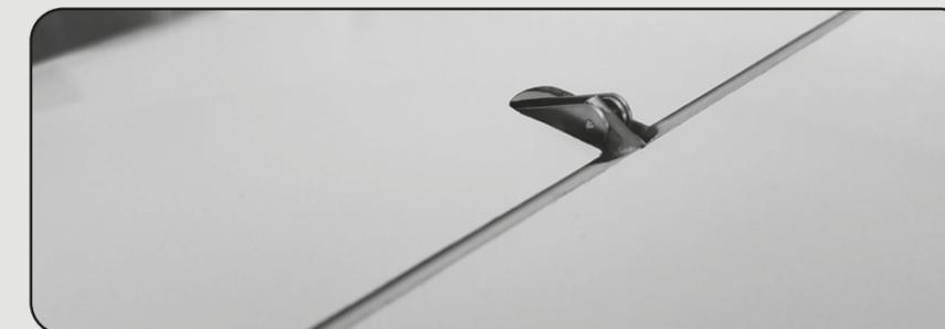
**06** Die Servoschachtabdeckung in der Aussparung der Tragfläche positionieren und z.B. mit Klebeband befestigen. **HINWEIS: Die Servoschachtabdeckung so positionieren, dass der Servohebel und das Gestänge nicht die Abdeckung berühren.** Den Bauschritt 4 – 6 für die Montage und Anschluss des zweiten Wölbklappenservos wiederholen.
