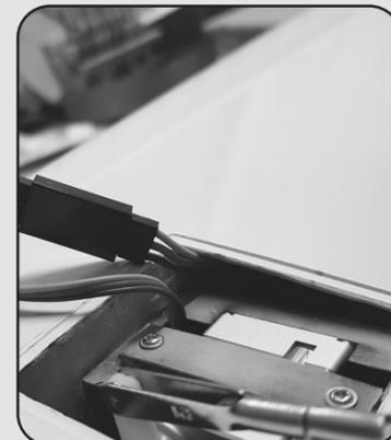
**05** Das Servo mit den Schrauben am Servorahmen im Servoschacht befestigen. Das fertige Gestänge am Servo und am Ruderhorn der Wölbklappe einklipsen. Das Gestänge durch drehen justieren, sodass die Wölbklappe genau mittig steht. Gabelköpfe und Muttern mit Schraubensicherungslack gegen verdrehen sichern.
