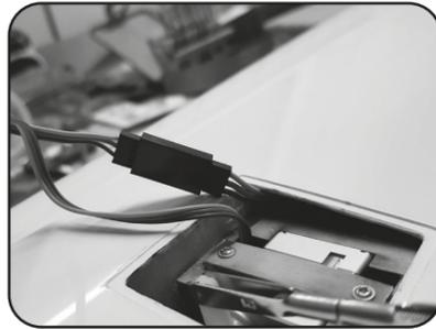
**02** Das Servo wie abgebildet mit den Schrauben am Servorahmen im Servoschacht befestigen. Das fertige Gestänge am Servo und am Ruderhorn der Querruderklappe einklipsen. Das Gestänge durch drehen justieren, sodass die Querruderklappe genau mittig steht. Die Gabelköpfe und ggf. Muttern mit Schraubensicherungslack gegen verdrehen sichern.
