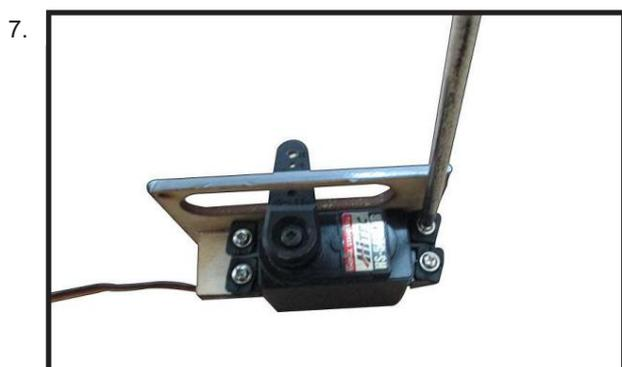
Appliquez 1 à 2 gouttes de C/A fin sur chacune des languettes de montage. Laissez le C/A durcir sans utiliser d'accélérateur.
