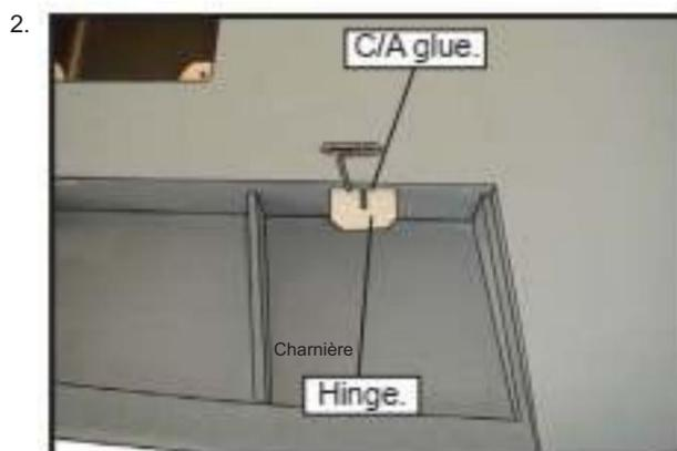
Faites glisser le panneau d'aile sur les genoux jusqu'à ce qu'il n'y ait qu'un léger espace. La charnière est maintenant centrée sur le panneau d'aile et sur le recouvrement. Retirez les goupilles en T et serrez l'aileron contre le panneau d'aile. Un espace de 1/64" ou moins doit être maintenu entre le panneau d'aile et le recouvrement.
