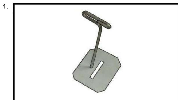
Retirez chaque charnière du panneau d'aile et de l'aileron et placez une goupille en T au centre de chaque charnière. Faites glisser chaque charnière dans le panneau de l'aile jusqu'à ce que la goupille en T soit bien ajustée contre l'aile. cela contribuera à assurer un montant égal de la charnière se trouve de chaque côté de la ligne de charnière lorsque l'aileron est monté sur l'aileron.
