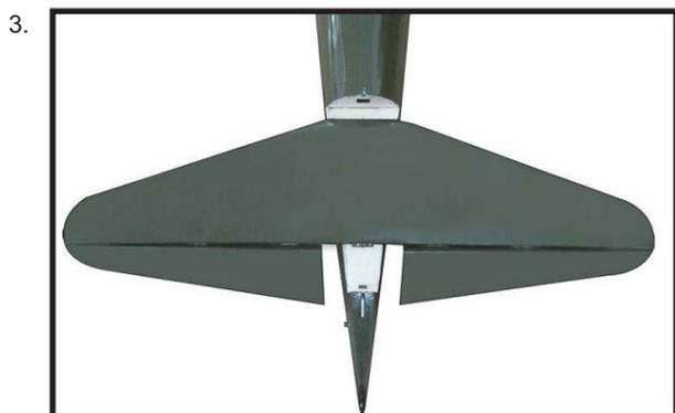
Une fois le stabilisateur fermement maintenu en place, utilisez un stylo et tracez des lignes sur le stabilisateur à l'endroit où celui-ci et les côtés du fuselage se rejoignent. Faites cela sur les côtés droit et gauche ainsi que sur le haut et le bas du stabilisateur.
