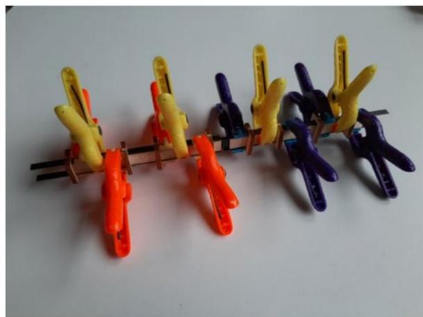
Coupez le surplomb des bandes de PRFC L2 et poncez un côté du boîtier du connecteur à plat au niveau de l'ouverture pour le connecteur. Vous n'avez pas besoin de meuler les côtés.
