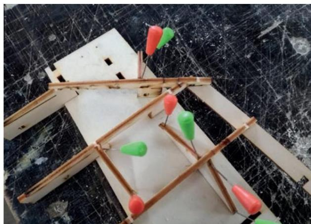
Insérez la bande de nez d'introduction collée dans les côtes. Vérifiez que le bord avant de la bandelette d'intronase affleure avec toutes les côtes. La nervure 19 doit également être parfaitement ajustée, sinon vérifiez à nouveau si la nervure 19 est bien en place. Le bord d'attaque de l'intro n'est pas encore collé.
