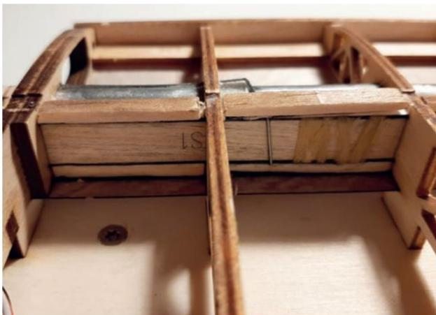
Collez le longeron CFRP à la barre de longeron avec de la colle époxy.
