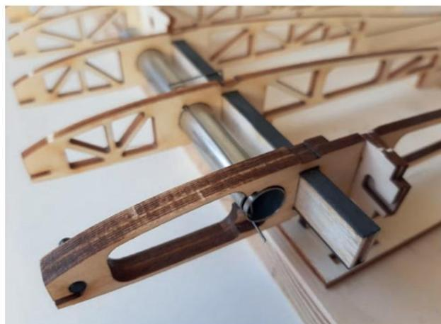
Insérez la fixation de la lisse d'aile dans la nervure 1. Sur l'aile droite, la découpe pour la lisse d'aile est à l'avant, avec l'arrondi du „P“ vers le haut. L'étiquetage doit être lu dans le bon sens. Avant de coller, assurez-vous de tester si le grand livre s'intègre dans la découpe sans aucun problème. Maintenant, vous pouvez encore légèrement retravailler.
