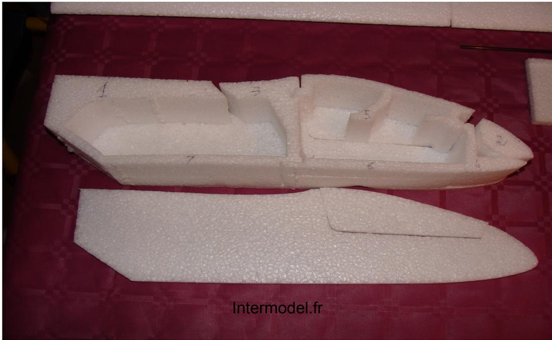
Le fuselage, notez la disposition des couples qui permettent le clipsage de la verrière.
