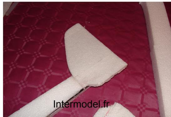
Rainurez les dérives ( attention, une gauche et une droite!!!) afin de laisser passer le tube carbone, puis collez en place.
