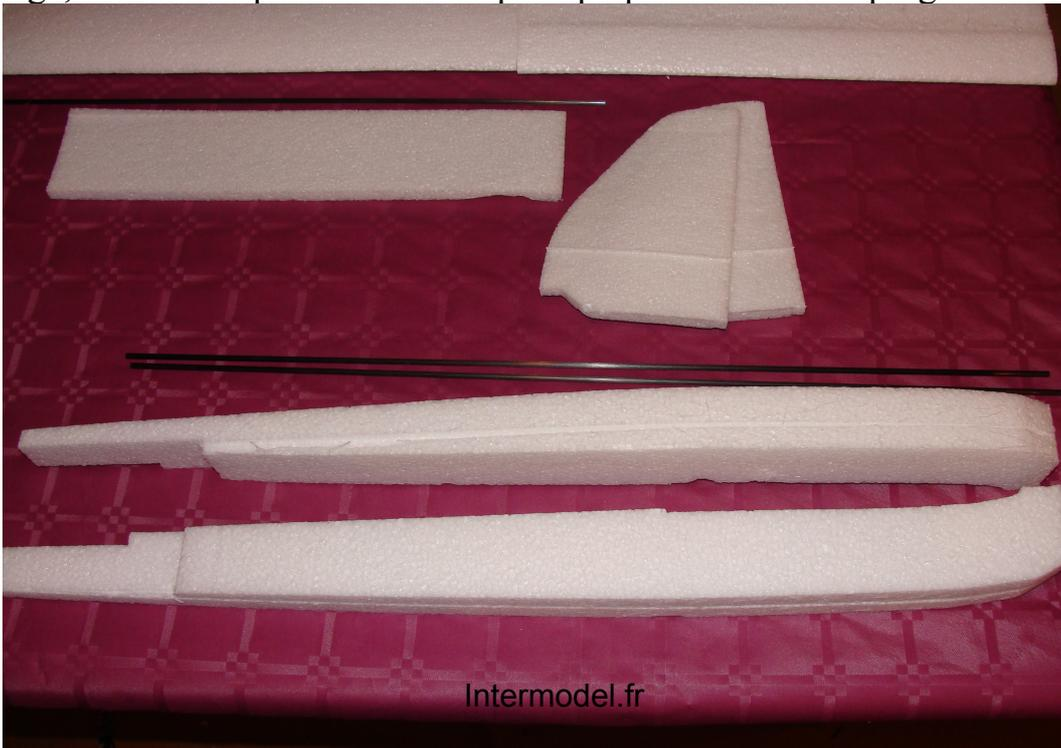
Les poutres, dérives, stab et les tubes carbone de renfort
