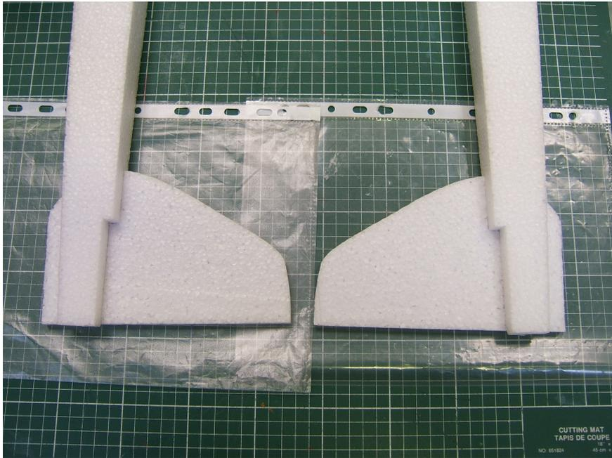
Préparez le stabilisateur : vous pouvez ajouter ( option ) en diagonale un plat carbone de 3x0,5mm dessus et dessous en les croisant. Pour cela, une entaille au scalpel est faite puis le plat est inséré après avoir ajouté **la colle cyano**. Le plat carbone 5x0,6mm est collé à **la cyano** au bord d'attaque du stabilisateur.
