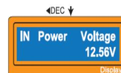
Si le câble d'équilibrage de la batterie est connecté sur le coté droit du chargeur vous pourrez vérifier la tension de chaque cellule (maximum 6 cellules)
